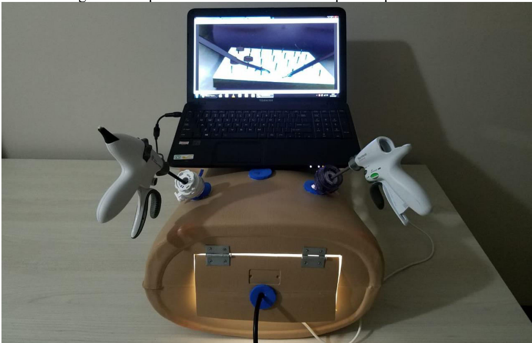
Figura 1 - Aspecto final do simulador de laparoscopia SIM-VLP
